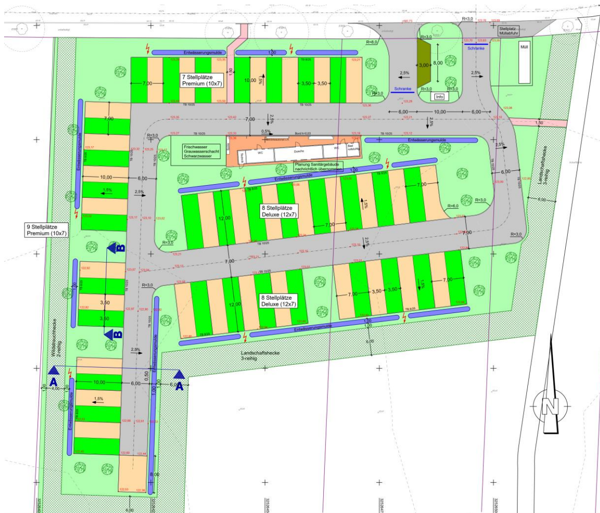
Abb. 7: Lageplan „Wohnmobilstellplatz“ - Entwurfsplanung Quelle: ZECH-CON Beratende Ingenieure GmbH (Stand: 03.04.2024) – ohne Maßstab – ΔNord
