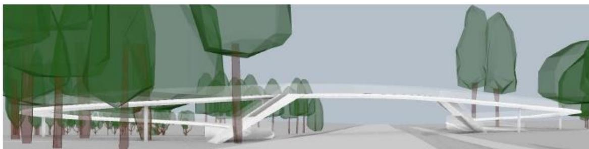
**Abb. 5: Variante 2 Hohlkasten als Sprengwerk und Durchlaufträger, Mittelstützweite beton**
