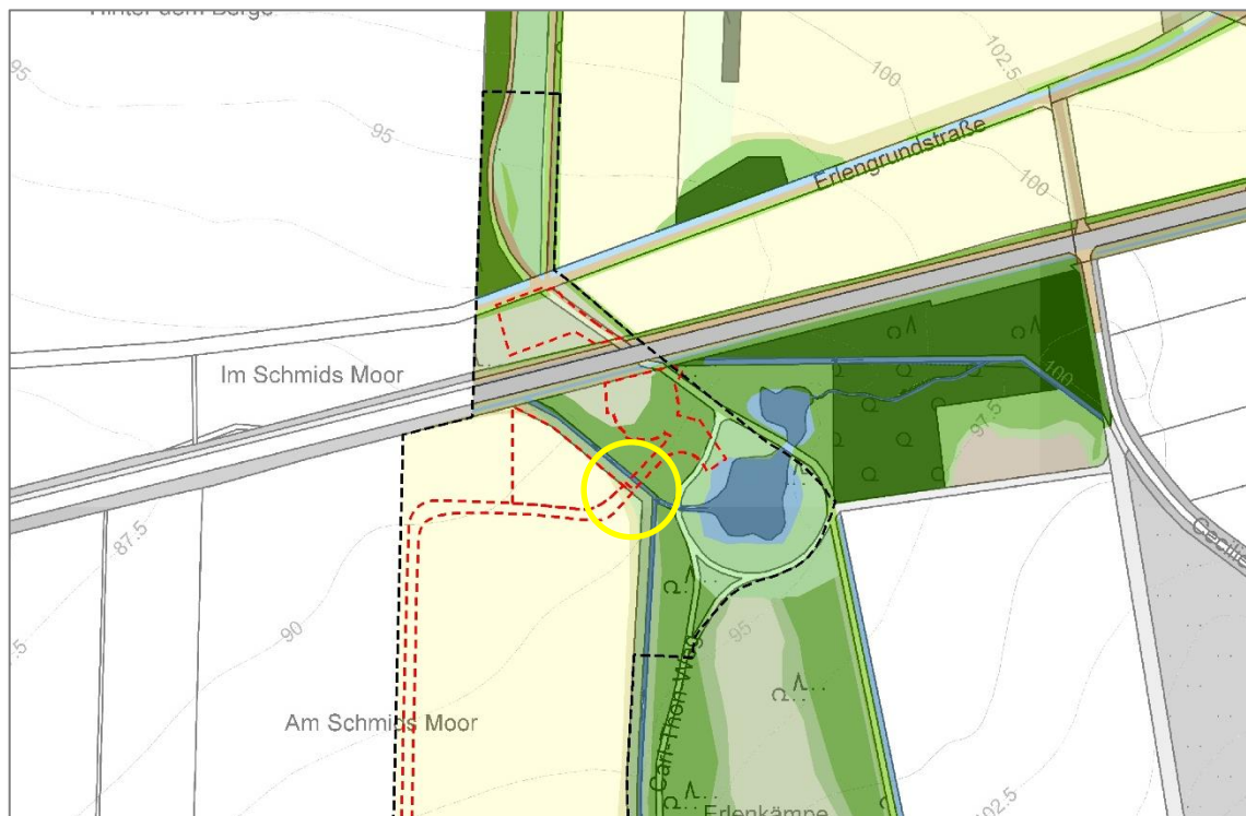
Abb. 9 Querungsbereich der Baustraße mit dem Gehölzbestand (gelber Kreis)
