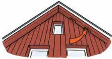
Abb. 14 CEF-Maßnahme: Spaltenquartier im Ortgang Maße der Einflugöffnung: 2,5 cm x 5 cm (NABU NRW, in Meier 2020)
