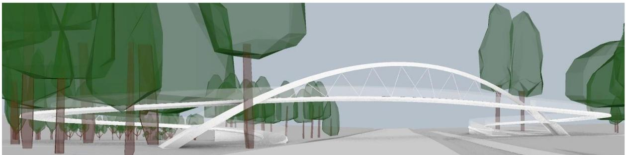
Abb. 7: Variante 3 diagonal über Brückentafel liegendes Bogentragwerk
