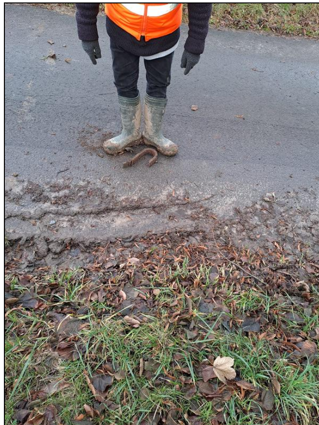
Abbildung 11 Abgebrochenes Endstück eines Blattfederpakets eines landwirtschaftlichen Anhängers
